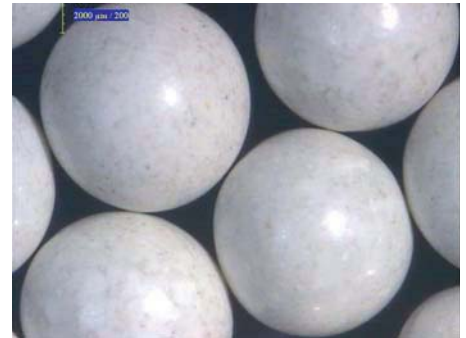
CERDUR-ZTA nach 72 h Mahltest; 12 m/s Umfangsgeschwindigkeit
